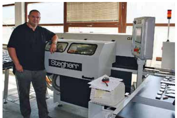
Bei der Profilleistensäge GLS-2 von Stegherr ist die Schnittführung in zwei Ebenen bis ±45° möglich
